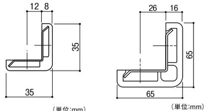
●材質: 本体・エンドキャップ/軟質塩化ビニル、取付下地材/アルミ
